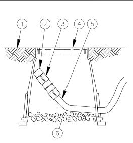
1) FINISH GRADE (2) FLUSH CAP FOR EASY FIT CORVRESSION FITTINGS: POTABLE: RAIN BIRD MDCFCAP NON-POTABLE: RAIN BIRD MDCFPCAP (3) EASY FIT COUPLING: RAIN BIRD MDCFCOUP (4) SUBTERRANEAN EMITTER BOX: RAIN BIRD SEB 7XB 5) SUB-SURFACE DRIPLINE: RAIN BIRD XF SERIES DRIPLINE POTABLE: XFS DRIPLINE NON-POTABLE: XFSP DRIPLINE 6) 3-INCH MINIMUM DEPTH OF 3/4-INCH WASHED GRAVEL WITH FILTER FABRIC AT BASE
