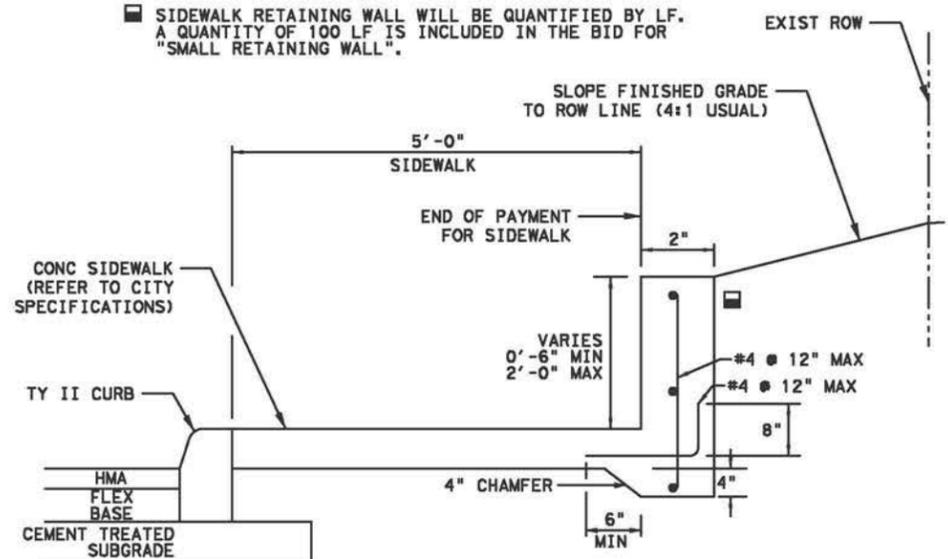
SIDEWALK RETAINING WALL DETAIL
