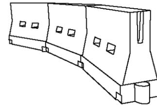
**LONGITUDINAL CHANNELIZING DEVICES (LCD)**
